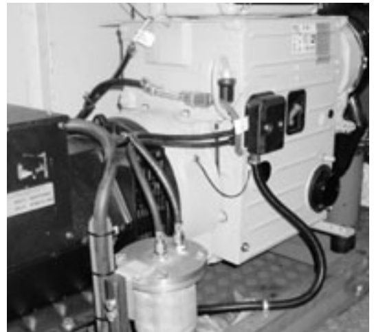
De oliefilters worden ook toegepast op andere machines. Zoals hier bij een aggregaat.
